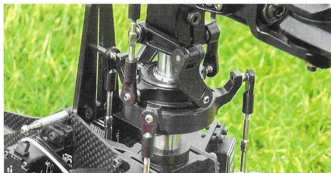
Blick auf einen Rotorkopf eines Flybarless-Helis
