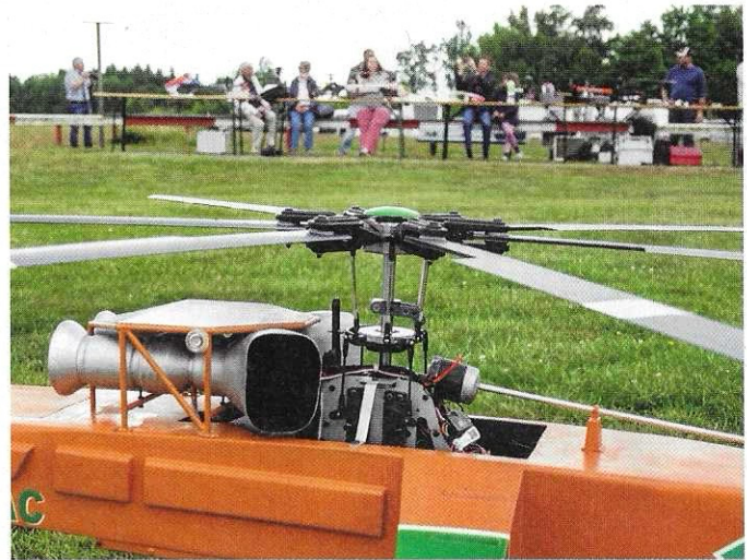
Detail am Sikorsky S-64 Airplane: Der Rotorkopf mit sechs Blättern ist ein Blickfang
